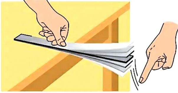
图2.2-1 探究音调和频率的关系
